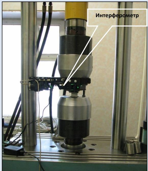
Испытательная машина INOVA ИК-6033, с ЭЦСИ-интерферометром
