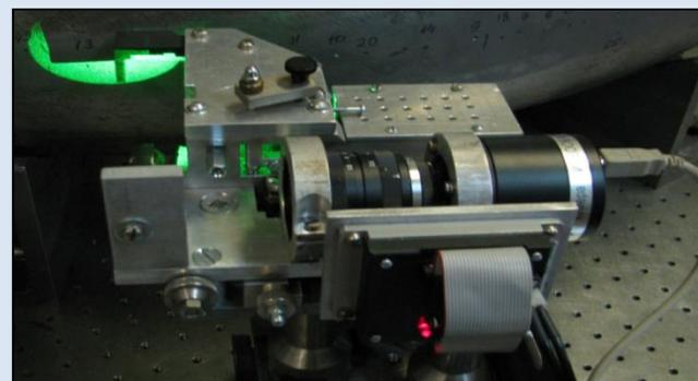
Малогабаритный ЭЦСМ-интерферометр для измерения деформационного отклика, обусловленного высверливанием отверстия
