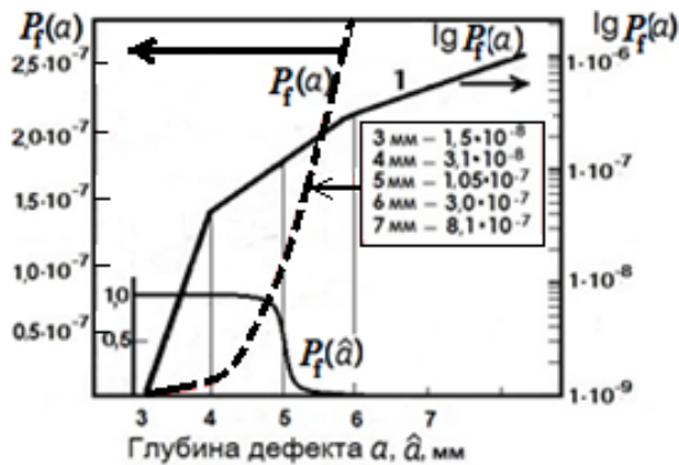
Рис. 1. Зависимости вероятности разрушения корпуса реактора АЭС - P_f(a) и вероятности P_f(\hat{a}) не превышения размера обнаруженного дефекта ( a_1 = 5 мм) от глубины дефекта
