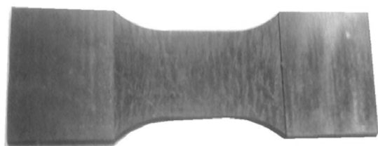
Рис.4. Образец, изготовленный из композиционного материала
