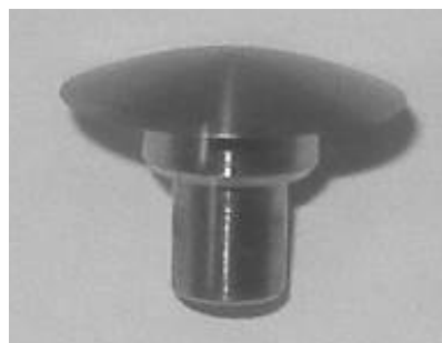
Рис. 1. Внешний вид контакта ПИЛТ из сплава ВТЗ-1 в исходном состоянии
