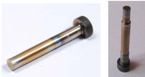
Рис. 1. Характер износа пуансонов
