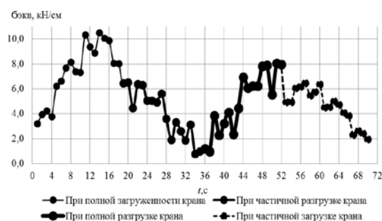
Рис. 4. График история блочного нерегулярного нагружения процессе работы литейного крана 180+63/20–33,5–36–3.
