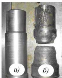
Рис. 2. Разрушение вала привода станка: а) - цельный вал; б) - разрушенный вал из-за чрезмерного нагружения
