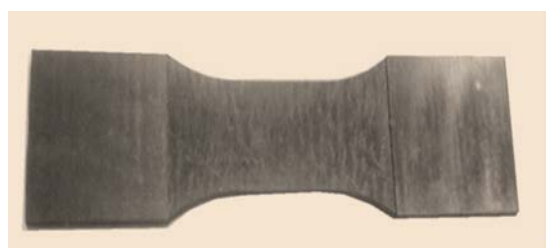
Рис.2. Образец, изготовленный из композиционного материала с дефектом типа «непроклей»
