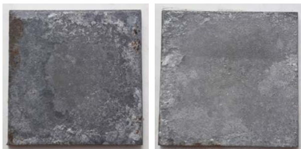
Рис. 2. Фотографии покрытий, упрочненных частицами Al_2O_3 и AlN после коррозионных испытаний
