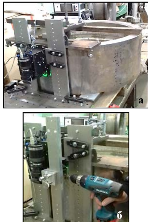
Рис. 1. Установка измерительного прибора (интерферометра) на образце-катушке (а). Засверловка отверстия-индикатора для определения остаточных напряжений (б).
