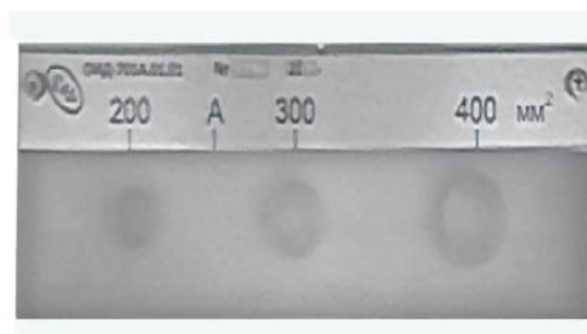
Рис 1. Штатный образец акустического дефектоскопа АД-701 из оргстекла
