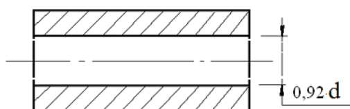
Рис. 1. Цилиндрическая заготовка: d – внутренний диаметр резьбы
