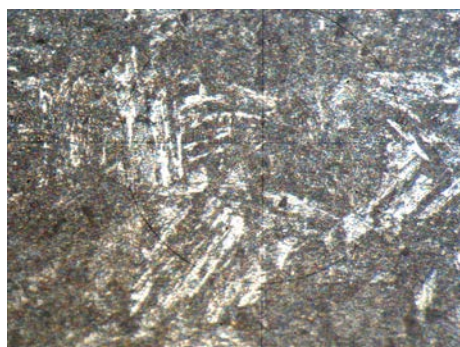
Рис. 2. Микроструктура материала перовой части рабочей лопатки 5-ой ступени, X 500
