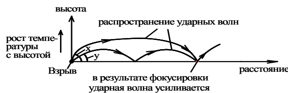
Рис. 2. Эффект фокусировки ударных волн при температурной инверсии
