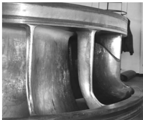
Рис. 1. Сквозная трещина в лопасти рабочего колеса радиально-осевой гидротурбины [4]
