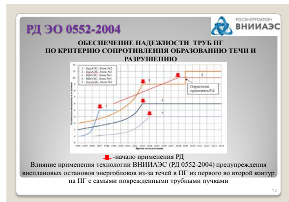
Рисунок 2 . За год до применения СКП число было 5 остановов блоков АЭС.
