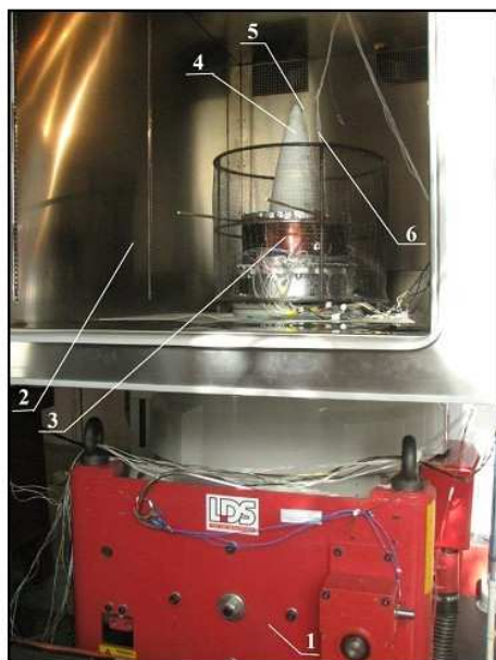
Рис. 3.1. Стенд для испытаний конструкций ЛА на комплексное воздействие вибраций тепла и холода в составе вибростенда и накатной климатической камеры. 1 – вибродинамическая система, 2 – накатная климатическая камера, 3 – нагревательное устройство, 4 – испытуемая конструкция ЛА; 5 – акселерометр, 6 – термопары
