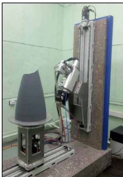
Рис. 3.6. Стенд исследований напряженно-деформированного состояния тонкостенных конструкций ЛА из композиционных материалов.
