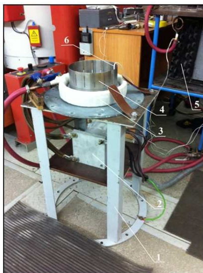
Рис. 3.5. Экспериментальная установка для исследований узла клеемеханического байонетного соединения шпангоута ЛА. 1 – опора, 2— конденсаторная батарея, 3 – индукционный нагреватель, 4 – узел клеемеханического байонетного соединения, 5 – автономная система охлаждения индуктора, 6 – термопары
