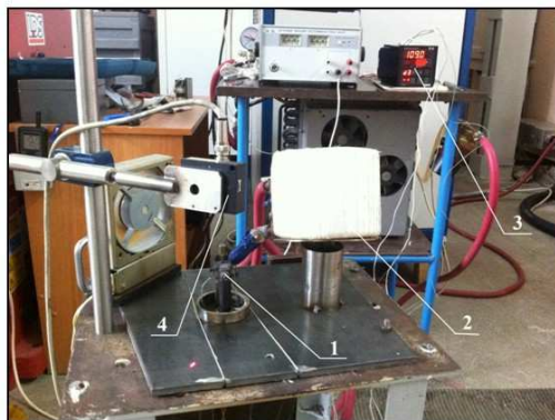
Рис. 3.7. Экспериментальная установка для исследований процессов ползучести, длительной прочности и долговечности клеевых соединений системы «металл-керамика». 1 – испытуемый образец, 2 – индукционный нагреватель, 3 – измерительный прибор, 4 – лазерный датчик перемещения
