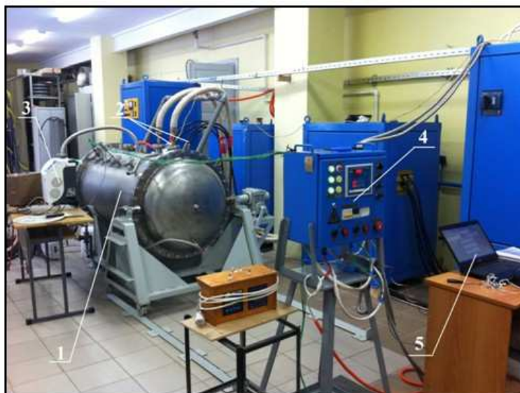
Рис. 3.3. Стенд для термовакуумных испытаний конструкций ЛА на комплексное воздействие вакуума и тепла в составе вакуумной камеры, силовых генераторов при использовании индукционных нагревателей и РНТТ при использовании гибких углеродных (тканых) нагревателей. 1 – вакуумная камера, 2 – гермотоководы, 3 – гелиевый течеискатель, 4 – система управления нагревом, 5 – система управления и регистрации параметров испытаний
