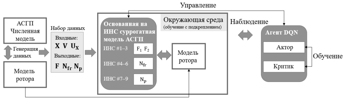
Рис. 2. Схема процедуры синтеза оптимального DQN контроллера активного гибридного подшипника
