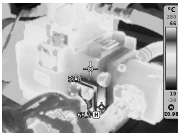
Рис. 4. Результаты замеров тепловыделения АПГМНД при технологической обкатке
