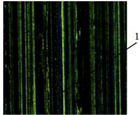
Рис.2. Микроструктура тонкопленочного покрытия, нанесенного плазменным методом. Увеличение \times 100 . 1 - тонкопленочное покрытие.
