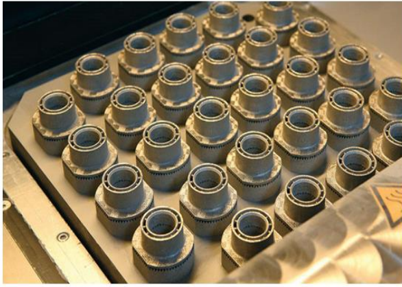
Рис.1. Завихрители фронтального устройства камеры сгорания двигателя ПД-14, изготавливаемые в ВИАМ [5]
