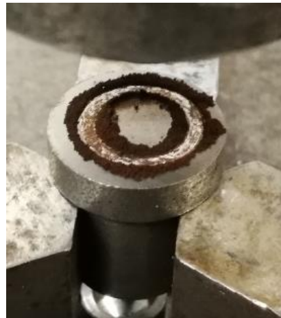
Рисунок 2 – Образец из стали 20 после испытания с контрообразцом из стали 20
