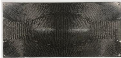
Рис. 5. Часть слоя композитной пластины с криволинейным армированием углеродным волокном [9]
