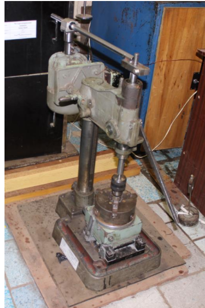
Рисунок 1 – Установка для испытания материалов на фреттинг-изнашивание
