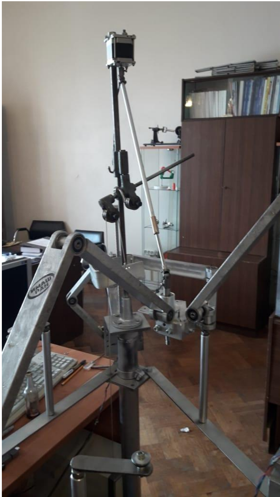
Рисунок 5.5 – Четвертая кинематическая цепь механизма, обеспечивающая дополнительную степень свободы
