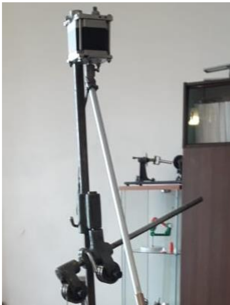
Рисунок 5.7 – Противовес и фрагмент дополнительной кинематической цепи
