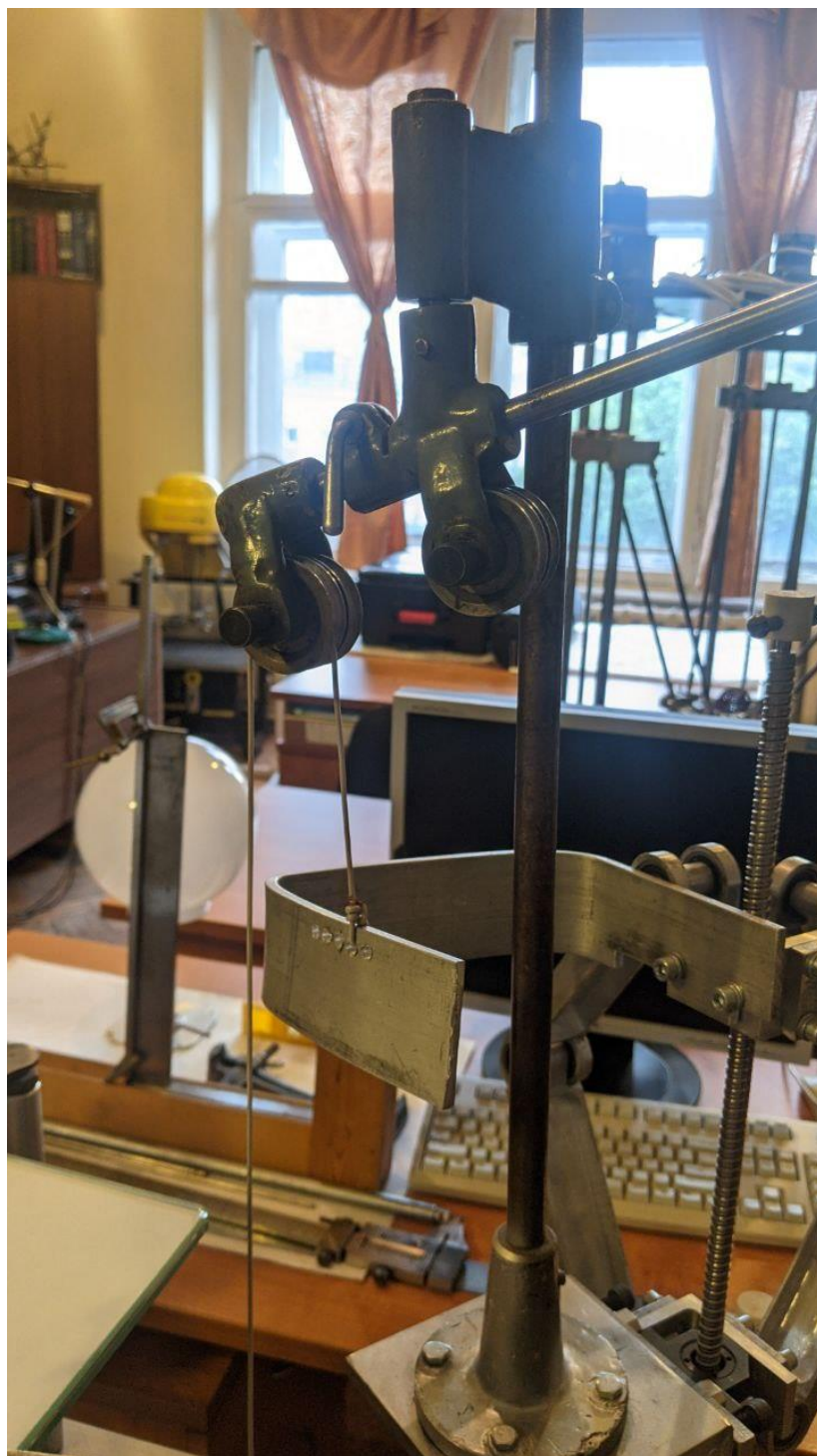
Рисунок 5.6 – Противовес с системой блоков для компенсации веса ВЫХОДНОГО звена
