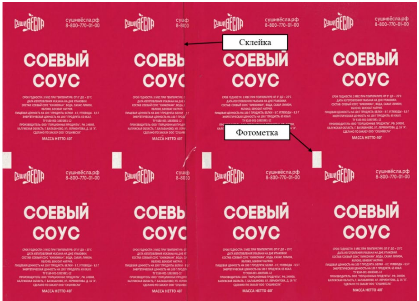
Рисунок 3.5 – Склейка на покровном материале.
