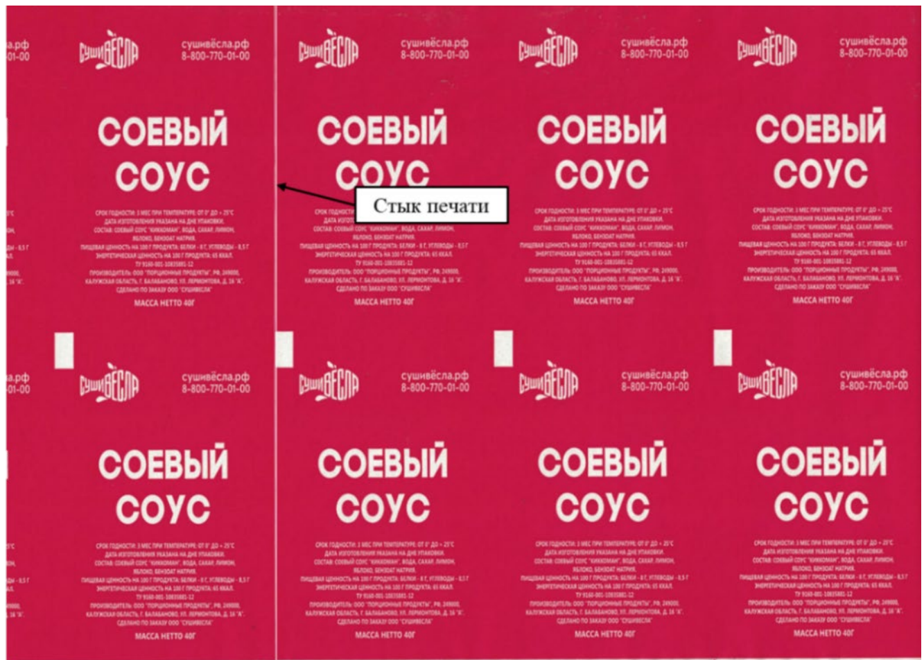
Рисунок 3.7 – Пример стыка печати этикеток на покровном материале.
