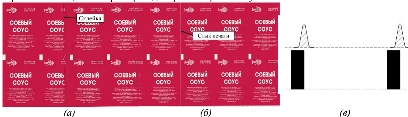
Рис. 8. Виды возмущений при автоматической сборке: (а) склейка на ленте; (б) стык печати; (в) погрешность измерения.
