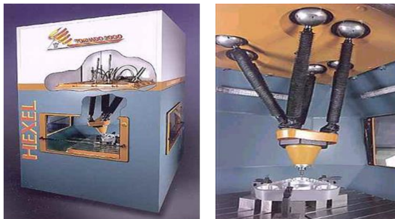
Рисунок 1.10 – Общий вид станка модели HEXE и его обрабатывающего узла
