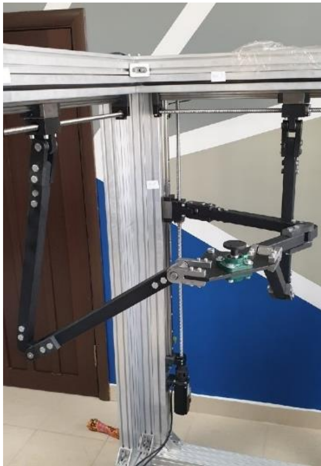
Рисунок 4.8 – Экспериментальный образец механизма для реабилитации нижних конечностей
