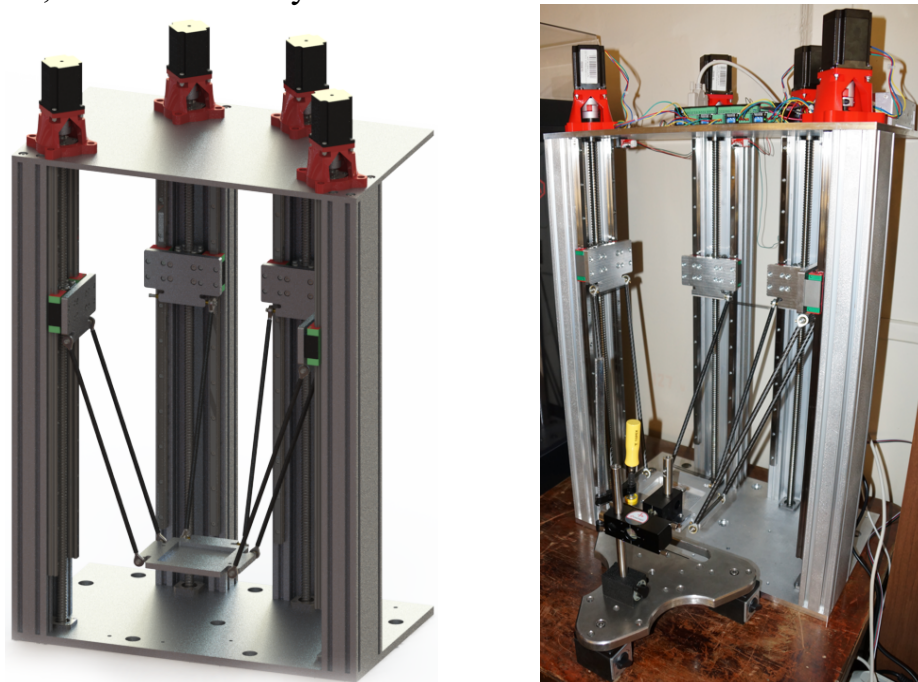
Рис. 25. Разработанное устройство: CAD-модель (слева) и фото в процессе отладки (справа)
