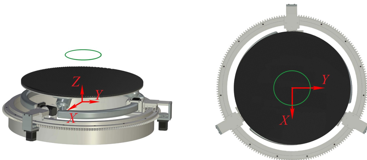
Рисунок 3.10. Моделирование траектории движения выходного звена механизма по окружности
