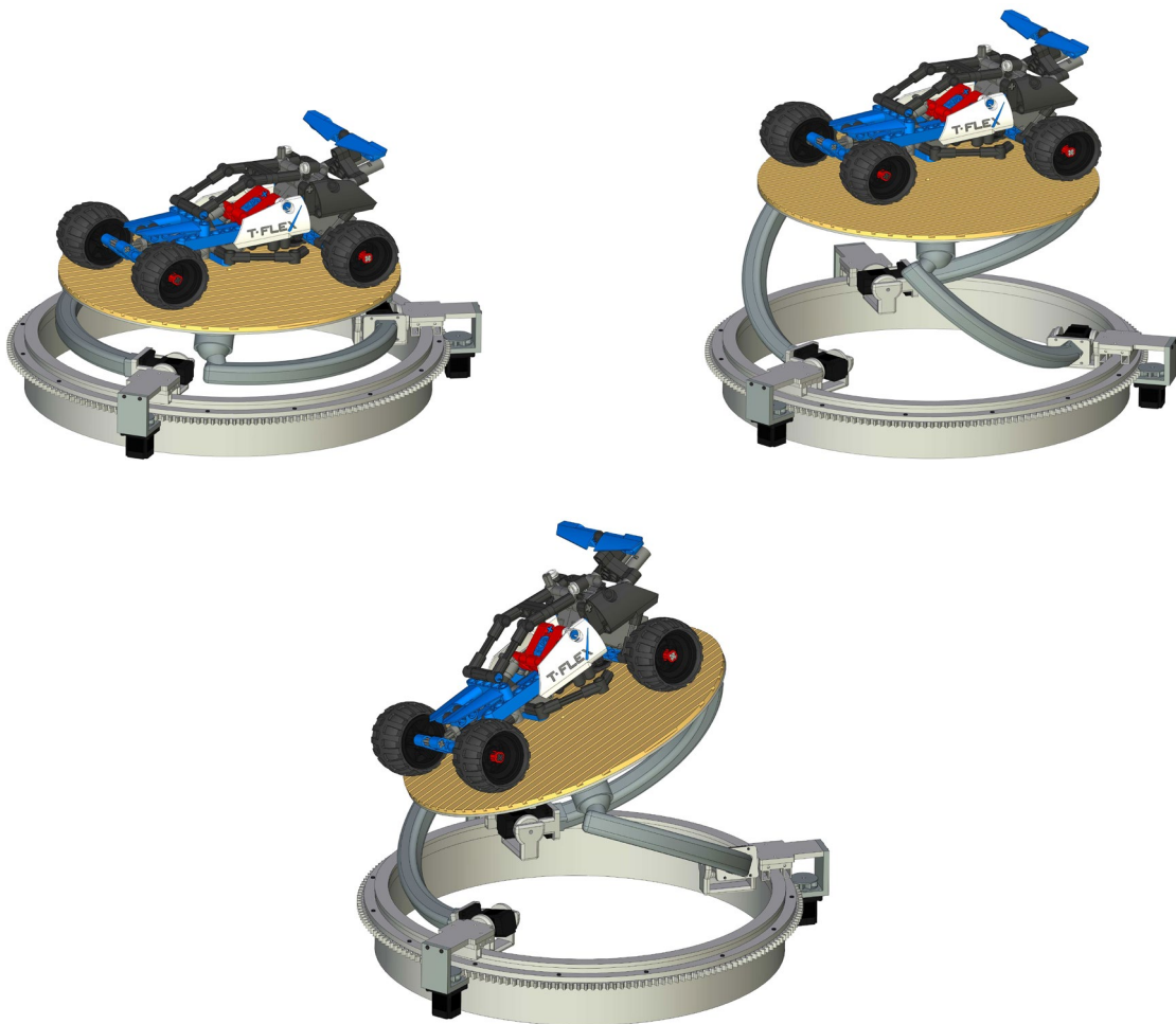
Рисунок 4.15. Многоподвижная ориентационная платформа-автотренажер
