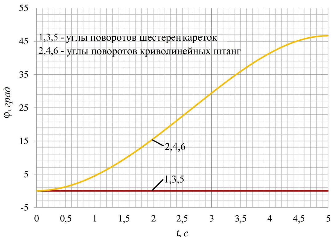
Рисунок 3.7. Диаграммы изменения углов отклонения шестерен кареток и криволинейных штанг при прямолинейной траектории движения платформы
