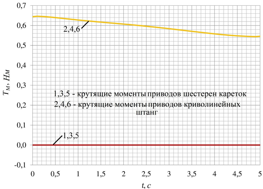
Рисунок 4.5. Диаграммы изменения моментов в приводах шестерен кареток и криволинейных штанг при движении платформы по прямолинейной траектории
