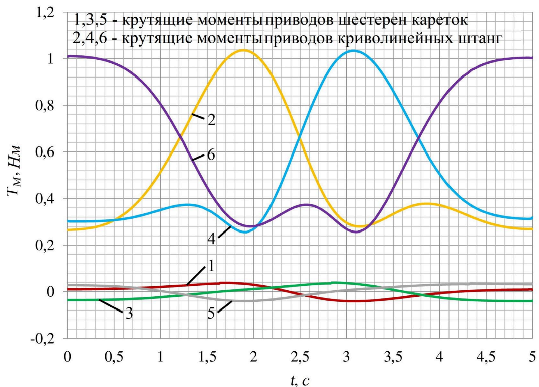
Рисунок 4.6. Диаграммы изменения моментов в приводах шестерен кареток и криволинейных штанг при движении платформы по окружности
