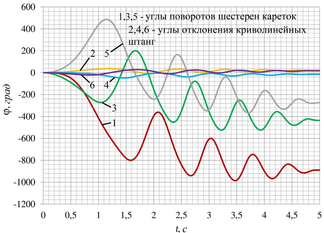
Рисунок 3.15. Диаграммы изменения углов отклонения шестерен кареток и криволинейных штанг при движении платформы по пространственной спирали
