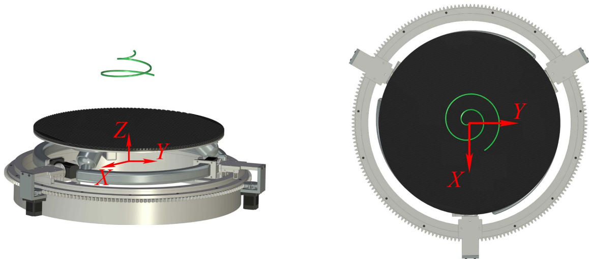
Рисунок 3.14. Моделирование траектории движения выходного звена механизма по пространственной спирали
