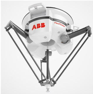
Рис. 1 Дельта-робот ABB FlexPicker
