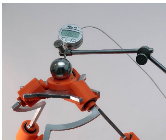
Рис. 19. Размещение шара и индикатора на выходном звене
