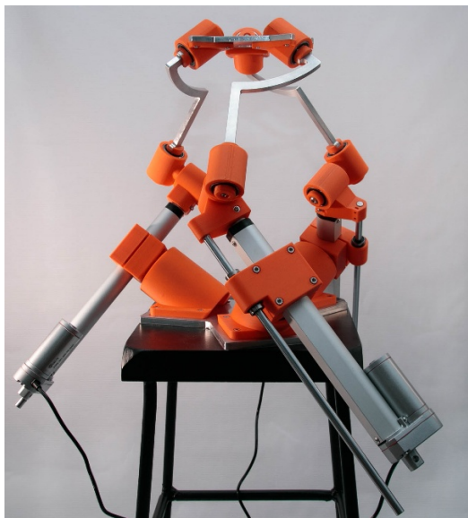
Рис. 17. Прототип механизма со втянутыми штоками
