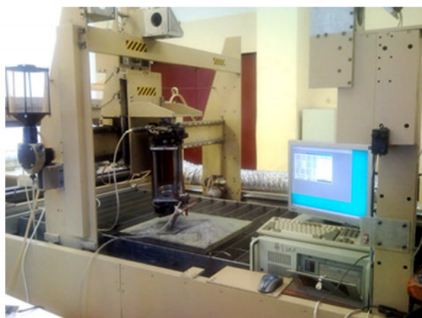
Автоматизированный технологический комплекс для упрочняющих и аддитивных лазерных технологий
