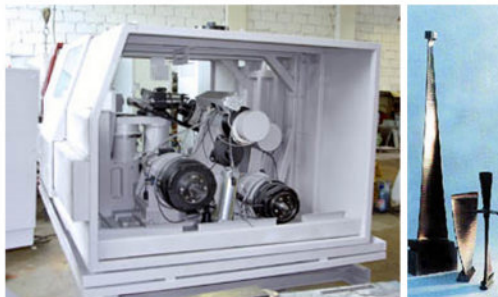
Робот-станок РОСТ-300 для финишной обработки пера лопаток реактивных двигателей
