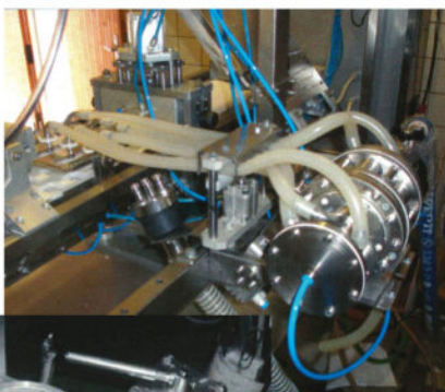
Роторный многоканальный дозатор жидких и полужидких продуктов
