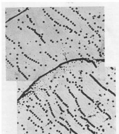
Образование полигональных границ при высокотемпературном циклическом нагружении
