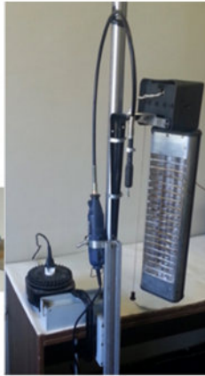
Исследование искусственной мышцы из спиральных полимерных нитей
