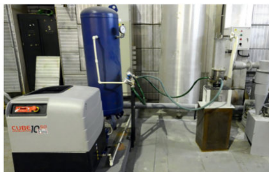
Экспериментальный стенд по изучению проблем волнового измельчения сыпучих материалов в вихревых газовых потоках
