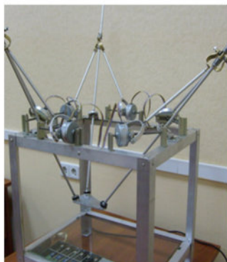
Манипулятор для испытаний моделей летательных аппаратов
