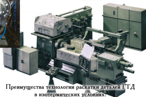
Стан для раскатки полых валов (СРВ) из жаропрочных сплавов в изотермических условиях из штампованных и листовых заготовок
