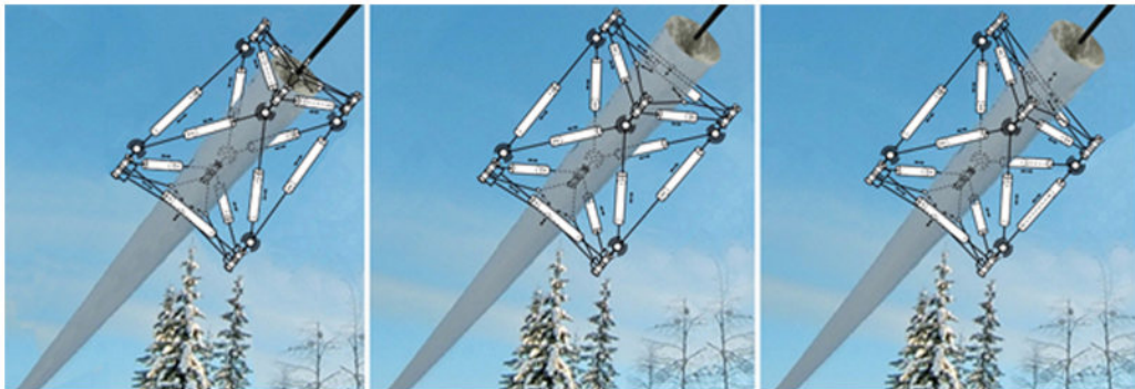
Самоперемещающийся параллельный робот для обслуживания и ремонта ЛЭП
