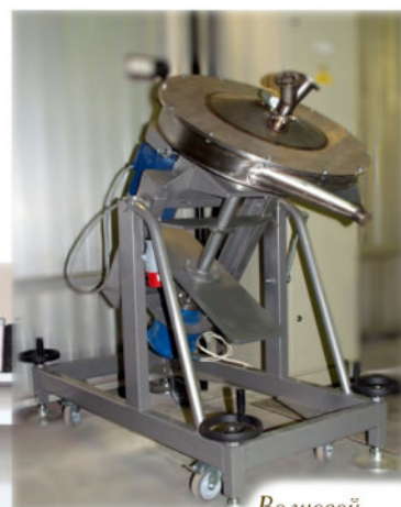
Волновой смеситель-активатор проточного типа для обработки сыпучих материалов
