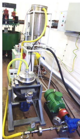
Лабораторный стенд для кавитационно-волновой обработки сверхвязкой нефти
