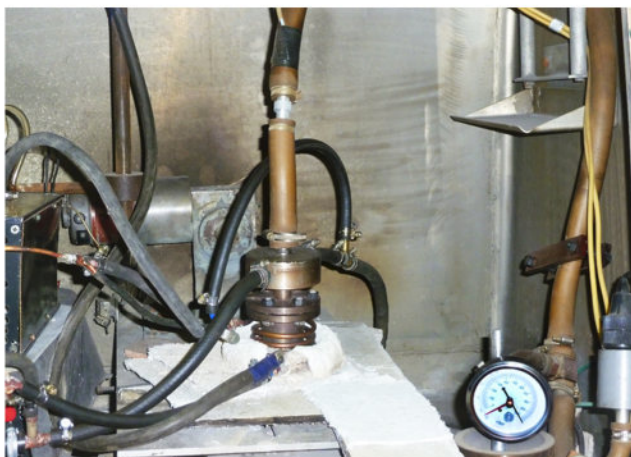
Стенд для насыщения металлокерамики парами селена и теллура
