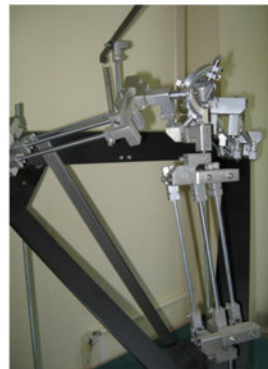
Манипулятор с карданными шарнирами и дополнительными тягами
