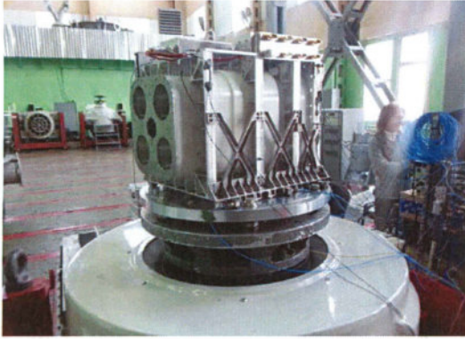
Натурные испытания прибора Френд (проект ЭкзоМарс) на вибростенде по заданному спектру возбуждения
