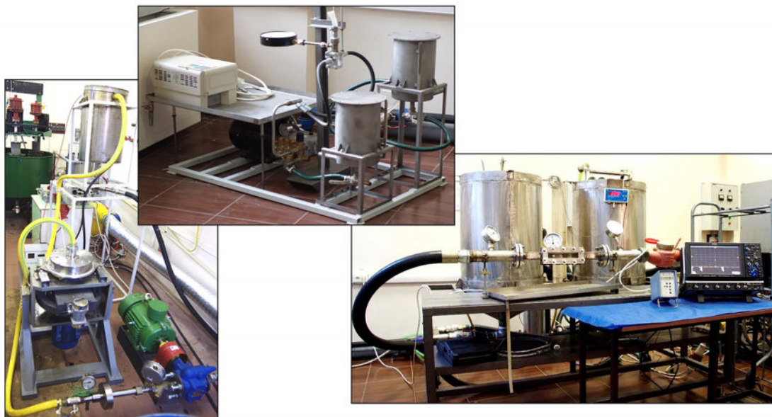
Технологические линии для кавитационно-волновой обработки жидких сред (тонкое и сверхтонкое измельчение, смешение и диспергирование суспензий и эмульсий)
