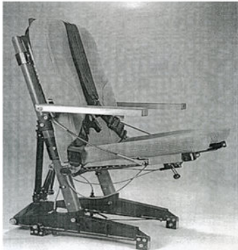
Активная гидropневматическая подвеска сидений различных транспортных средств с повышенными виброзащитными свойствами
