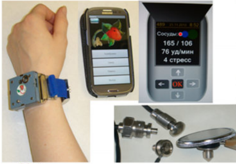
Мобильное устройство диагностики сердечно-сосудистой системы с беспроводной связью
