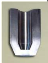
Рис. 2. Срез выдавленного образца из стали 12Х18Н9Т.
