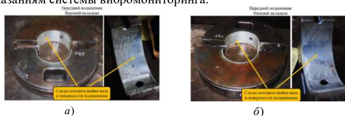
Рис.1. Следы контакта шейки вала и поверхности переднего подшипника компрессора: а) – на верхнем и б) – на нижнем вкладышах.
