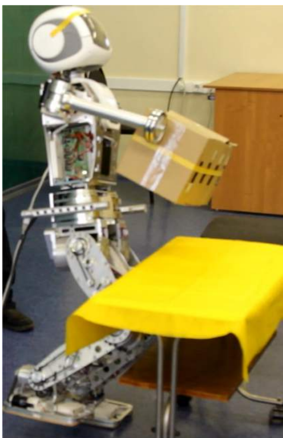
Рис. 1. Пример управляемого движения андроида – перенос груза в боковом направлении.
