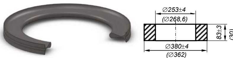
Рис. 1. 3D-модель и эскиз армирующего кольца сильфона.
