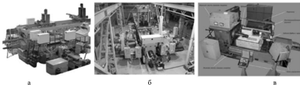
Рис. 1. Экспериментальные образцы станов для раскатки дисков из жаропрочных сплавов СРЖД-800 (а), АЛРД-800 (б) и полых валов СРВ (в).
