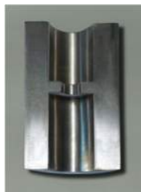
Рис. 2. Срез выдавленного образца из стали 12Х18Н9Т.
