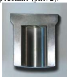
Рис. 2. Срез выдавленного образца из стали 12Х18Н9Т.
