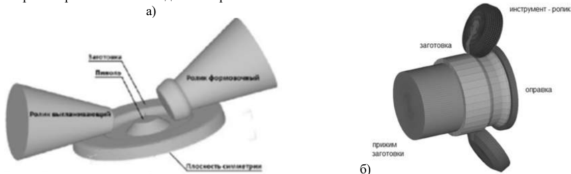
Рис. 1. Геометрическая модель раскатки диска (а) и полого вала (б).
