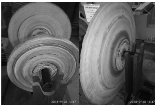
Рисунок 1. Образцы дисков, раскатанных из титанового сплава BT-9.
