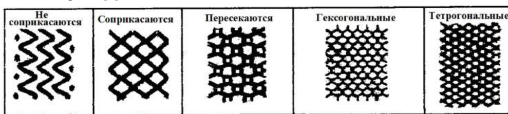
Рис. 1. Виды конфигураций при нанесении углублений с помощью метода поверхностно пластического деформирования (ППД).
