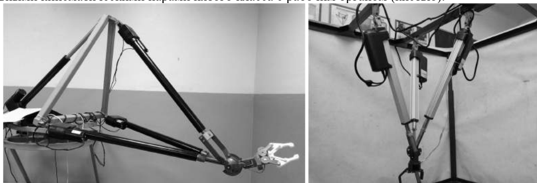
Рис.1. Манипуляторы параллельно-последовательной структуры на основе трипода.
