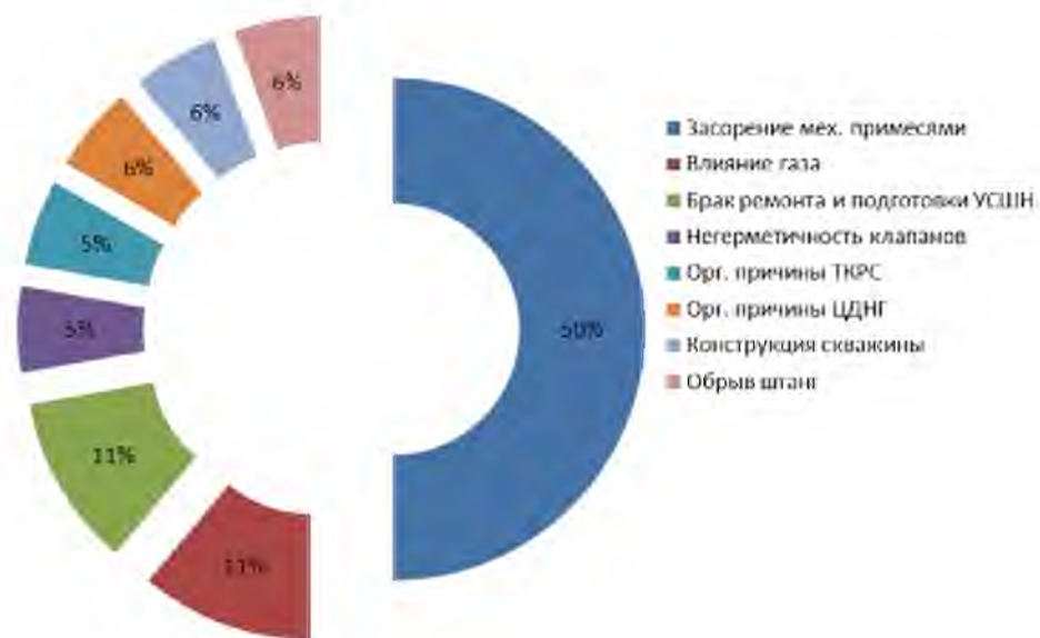
Рисунок 4.12 - Причины отказов УСШН в ООО «РН-Пурнефтегаз» в 2012 г.
