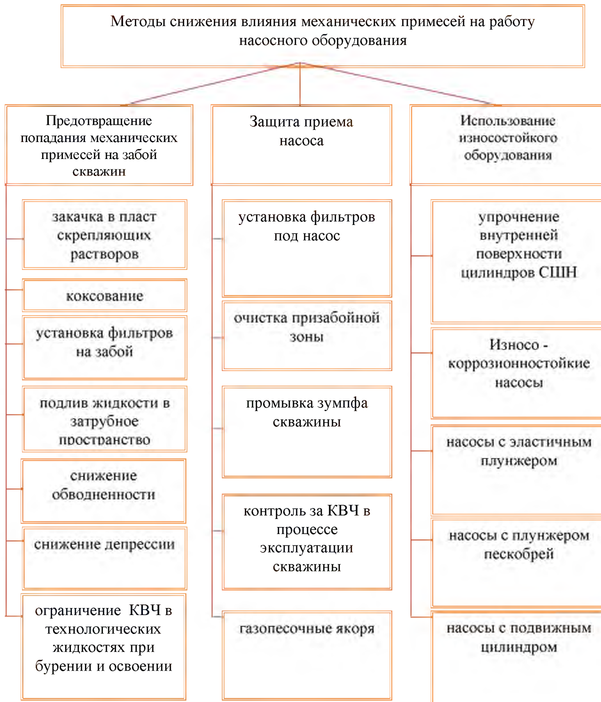
Рисунок 4.1 - Структурная схема методов защиты внутрискважинного оборудования от механических примесей
