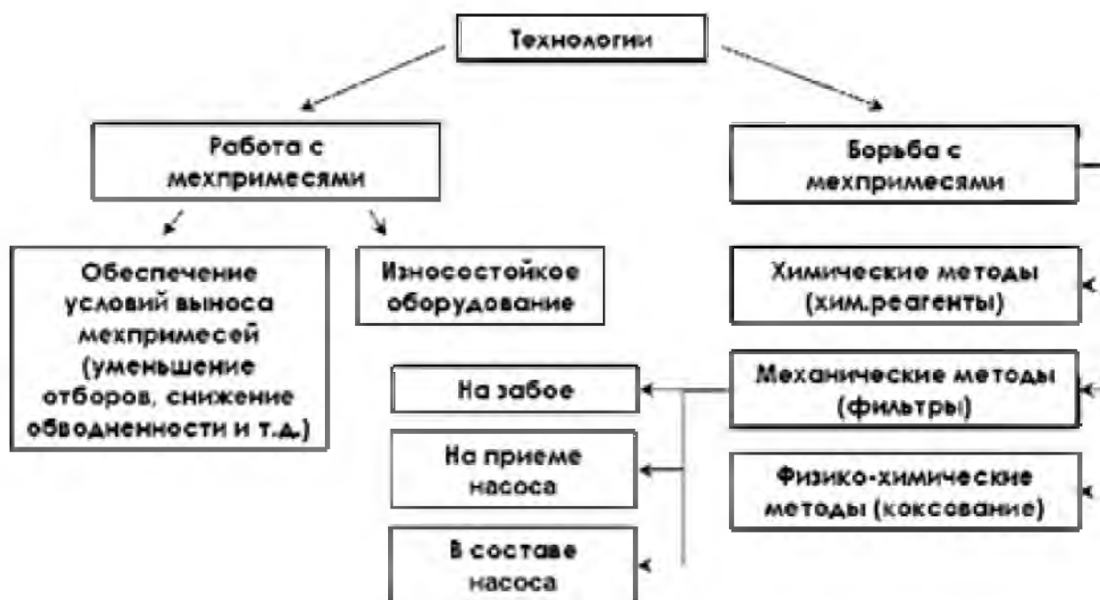
Рисунок 2.1 - Технологии насосной эксплуатации скважин с выносом механических примесей
