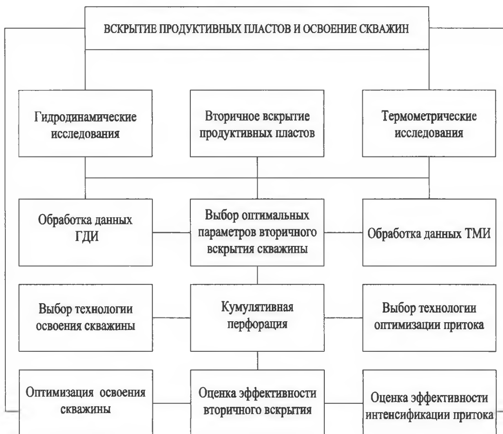
Рис. 5. Функциональная схема оптимизированного вскрытия продуктивных пластов и освоения скважин на основе аппаратно-программного комплекса.
