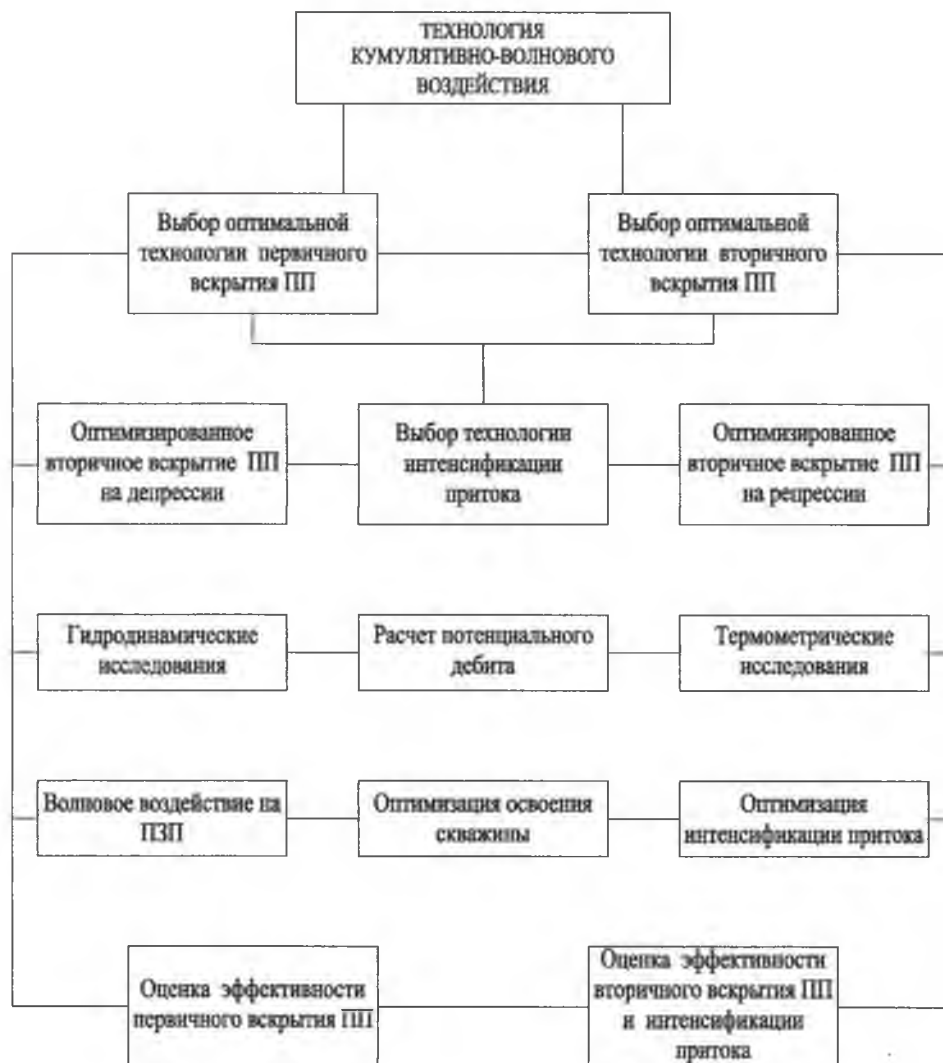
Рис. 1. Технологическая схема оптимального вскрытия продуктивных пластов и освоения скважин на основе кумулятивно-волнового воздействия.
