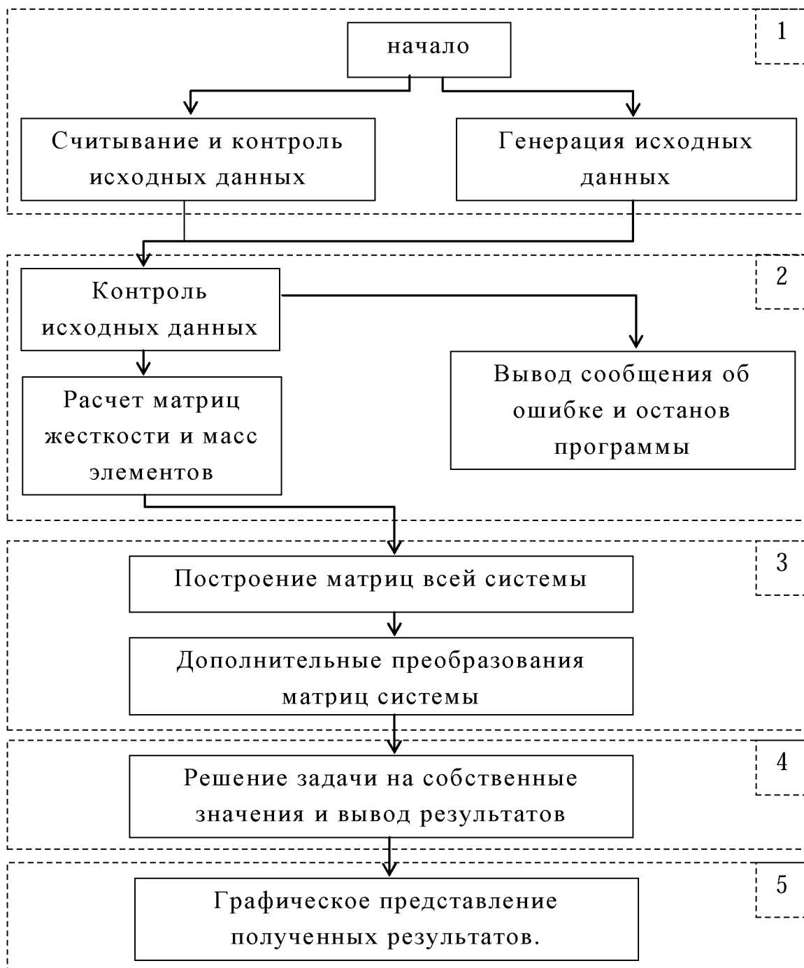
Рис.5.1. Структурная схема программы расчета собственных колебаний рабочих колес
