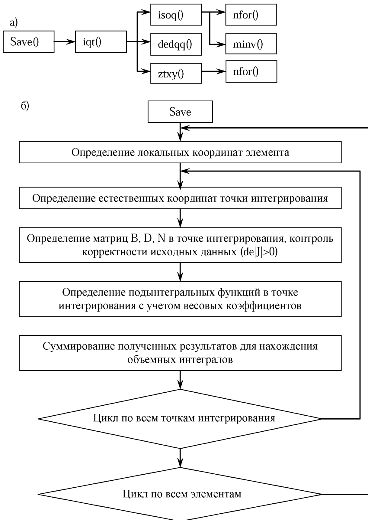
Рис. 5.2. Расчет матриц жесткости и масс элементов а) –структурная схема подпрограммы save; б) – блок-схема
