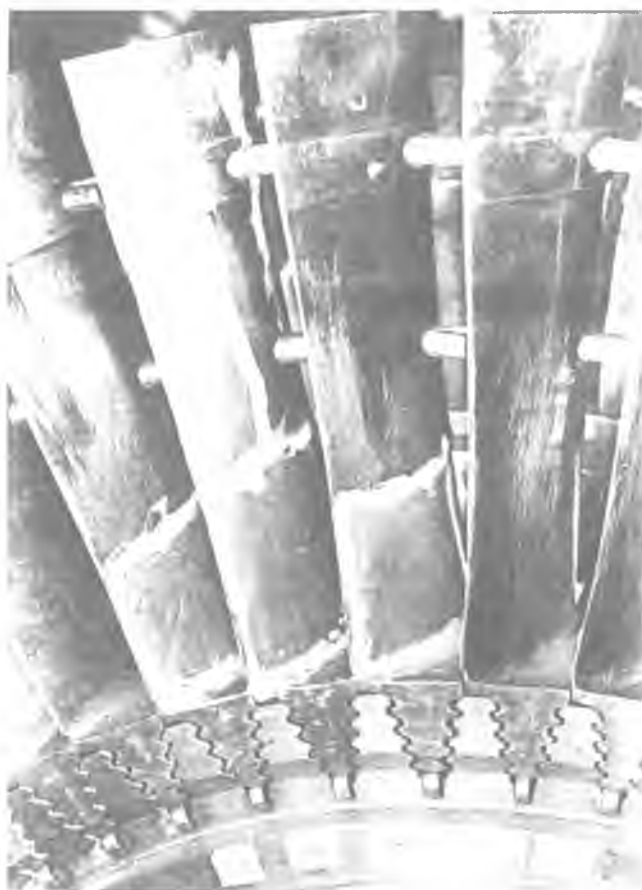
Рис. 5.7. Фрагмент рабочего колеса восьмой ступени паровой турбины К6-30П с закрепленными на лопатках тензодатчиками
