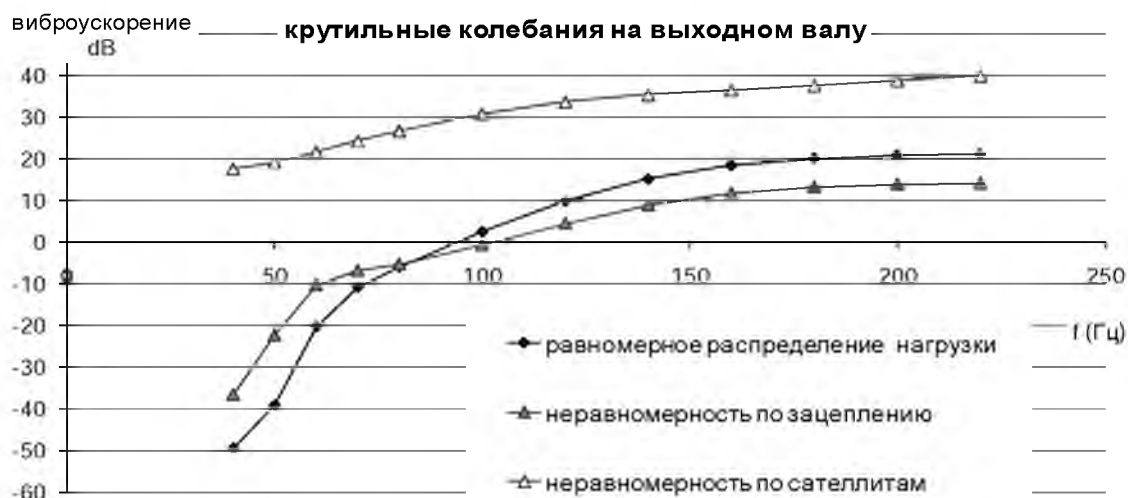
Рис. 4.15. Влияние неравномерности распределения нагрузки по зацеплениям и по сателлитам на АЧХ колебаний выходного вала редуктора на частоте пересопряжения зубьев второй ступени
